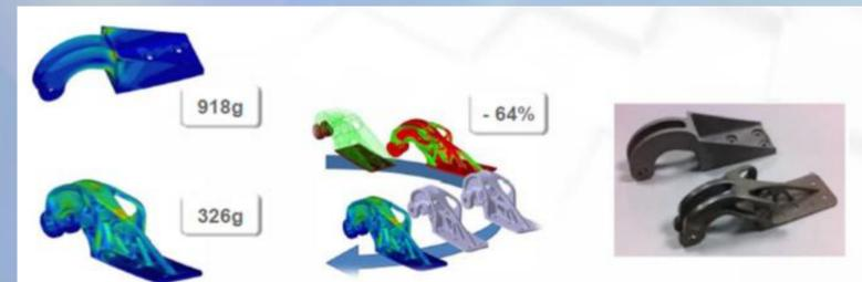
La fabrication additive permet de gagner du poids sur des ensembles par l'optimisation topologique
