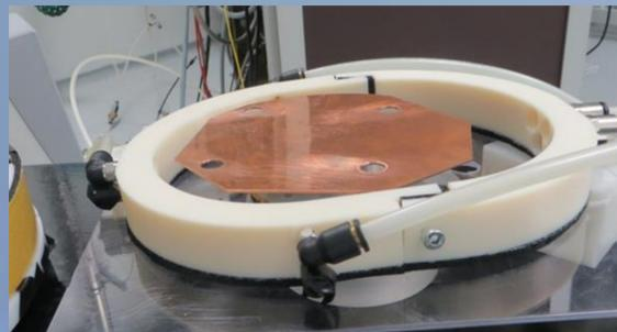
Anneau de soufflage pour le refroidissement de capteurs silicium sur la machine à pointes du LPNHE (ATLAS)
