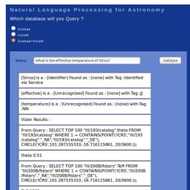
Un premier prototype pour l'interrogation des services du CDS en langage naturel. Une détection des mesures et des identifiants génère des requêtes pour Simbad et/ou Vizier.
