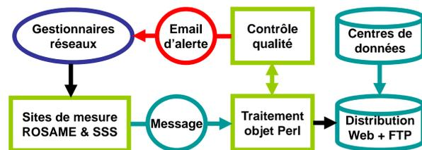
Figure 4. Schéma de fonctionnement du traitement automatisé et mutualisé entre les réseaux d'observations.
