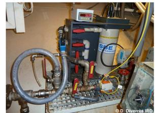
Figure 2. Thermosalinographe en salle des machines.
